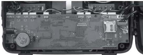
Diese Batterie dient als Schutz vor Verlust von Datum und Uhrzeit durch Ausfall der Stromversorgung des Senders, beispielsweise wegen Akkuwechsels.
