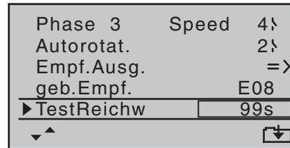
Mit dem Auslösen des Reichweitetests wird die Ausgangsleistung des Senders signifikant reduziert und die blaue LED am Antennensockel beginnt zu blinken. Zeitgleich startet die Zeitanzeige im Senderdisplay rückwärts, und alle 5 Sekunden ertönt ein 2-fach-Ton.
