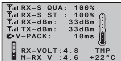
Dieses Display stellt die auch im Display »RX DATA-VIEW« des Telemetrie-Menüs »EINSTELLEN/ANZEIGEN« einsehbaren Daten in grafisch aufbereiteter Form dar.
