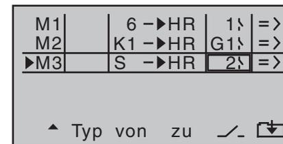
In diesem Beispiel wurden bereits drei Mixer definiert. Den zweiten Mixer kennen Sie bereits aus dem Menü »**Flächenmix**« („Bremse → HR“). Grundsätzlich sollten Sie diese vorprogrammierten Mixer aber zuerst nutzen. Falls Sie allerdings unsymmetrische Mischanteile benötigen oder den Mixerneutralpunkt verschieben müssen, dann stellen oder belassen Sie die vorprogrammierten
