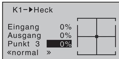
Standardmäßig ist eine Drehmomentausgleichskurve mit einem linearen Mischanteil von einheitlich 0 % vorgegeben, wie sie für einen im „Heading-Lock-Modus“ arbeitenden Gyrosensor erforderlich ist, siehe vorstehende Abbildung.
