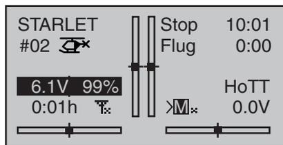
Die Stoppuhr startet nun nach Betätigung des zugeordneten Schalters bei dem eingestellten Anfangswert rückwärts („Timerfunktion“). Nach Ablauf der Zeit bleibt der Timer nicht stehen, sondern läuft weiter, um die nach 0:00 abgelaufene Zeit ablesen zu können. Zur eindeutigen Unterscheidung wird diese invers angezeigt.
