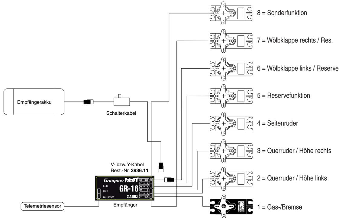
Bedingt durch den unterschiedlichen Einbau der Servos und Ruderanlenkungen kann anfangs die Servolaufrichtung bestimmter Servo verkehrt sein. Nachfolgende Tabelle gibt Hinweise zur Abhilfe.
