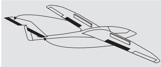
Beim Setzen von Wölbklappen, egal ob per »**Phasentrim**« oder mittels einem dem Eingang „E6“ zugewiesenen Geber, können als Nebeneffekte auf- oder abkippende Momente um die Querachse entstehen. Ebenso gut kann aber auch erwünscht sein, dass z.B. das Modell beim leichten Hochstellen der Wölbklappen auch eine etwas flottere Gangart an den Tag legt. Mit diesem Mischer kann beides erreicht werden.
