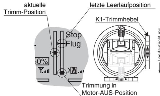
Diese Abschalttrimmung ist deaktiviert, wenn im Menü »**Grundeinstellung**« in der Zeile „Motor an K1“ „kein“ bzw. „kein/inv“ eingetragen ist (Seite 56/57).
