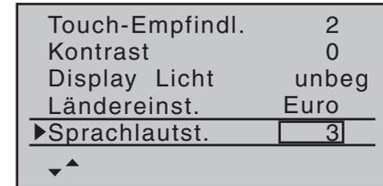
In dieser Zeile wird die Lautstärke der über den Ohrhöreranschluss erfolgenden Sprachausgabe im Bereich von „0“ bis „10“ festgelegt.
