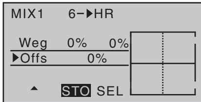
Die punktierte vertikale Linie in der Mitte der Grafik kennzeichnet die Lage des Mixerneutralpunktes („Offset“), also desjenigen Punktes entlang dem Steuerweg, bei dem der Mixer den an seinem Ausgang angeschlossenen Steuerkanal NICHT beeinflusst. Standardmäßig befindet sich dieser Punkt in der Steuermitte.
