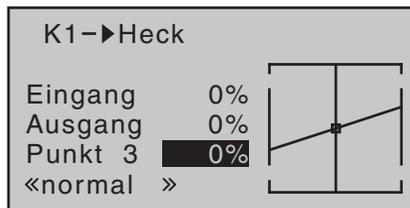
Ausgehend von -30 % bei Punkt 1 und +30 % bei Punkt 5 ist die Mischereinstellung derart vorzunehmen, dass der Hubschrauber auch bei längeren senkrechten Steig- und Sinkflügen nicht durch das gegenüber dem Schwebeflug veränderte Drehmoment des Hauptrotors um die Hochachse wegdreht. Im Schwebeflug sollte die Trimmung nur über den (digitalen) Heckrotortrimmhebel erfolgen.
