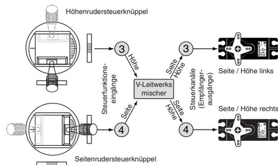
Die Software des Senders **mx-16** HoTT enthält bereits eine Vielzahl vorprogrammierter Koppelfunktionen, bei denen zwei (oder mehrere) Steuerkanäle miteinander vermischt werden. So kann der eben als Beispiel genannte Mischer in der Zeile „Leitwerk“ im Menü »**Grundeinstellung**« in Form von „V-Leitw“ softwaremäßig aktiviert werden.
