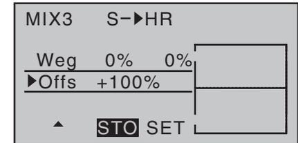
Wechseln Sie nun mit der Pfeiltaste ▲ der linken oder rechten Touch-Taste in die Zeile „Weg“ und berühren dann die zentrale **SET**-Taste der rechten Touch-Taste. In den nun inversen Wertefeldern stellen Sie – nachdem Sie den ausgewählten Schalter in die Mixer-EIN-Stellung gebracht haben – den benötigten Mischanteil mit den Pfeiltasten der rechten Touch-Taste ein.
