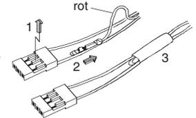
Falls Sie weitere Programmierungen wie z. B. Fail-Safe-Einstellungen vornehmen möchten, trennen Sie die dreipolige Satelliten-Verbindung zwischen den beiden Empfängern und schalten Sie nur den betreffenden Empfänger ein. Ggf. müssen Sie auch die Bindungs-Reihenfolge ändern.
