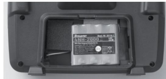
Den Akku entnehmen und dann Stecker des Senderakkus durch vorsichtiges Ziehen am Zuleitungskabel lösen.
