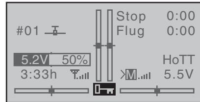
Die Sperre ist sofort aktiv, die Steuerung bleibt aber weiterhin betriebsbereit. Erneutes Berühren der Tasten **ESC** und **SET** über ca. zwei Sekunden hebt die Sperre wieder auf. Nach dem nächsten Einschalten des Senders ist die Sperre ebenfalls wieder aufgehoben.
