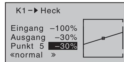
Schalten Sie jetzt versuchsweise wieder in die Autorotationsphase. Auch hier wird die Einstellung deaktiviert, das Heckservo reagiert nicht mehr auf Pitchbewegungen (im antriebslosen Zustand des Hauptrotors entsteht ja üblicherweise kein Drehmoment).
