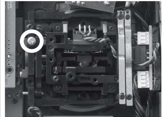
Drehen Sie nun diese Schraube hinein, bis der betreffende Steuerknüppel von Anschlag bis Anschlag frei beweglich ist bzw. drehen Sie diese heraus, bis der Steuerknüppel wieder komplett selbstrückstellend ist.
