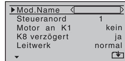
Hier wird nun der „Modellname“ eingetragen, indem mit einer Berührung der zentralen **SET**-Taste der rechten Touch-Taste zur Zeichentabelle gewechselt wird:
