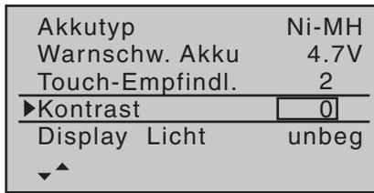
Berühren Sie anschließend kurz die zentrale Taste **SET** der rechten Touch-Taste. Im nun inversen Wertefeld können Sie mit den Pfeiltasten der rechten Touch-Taste den Display-Kontrast im Bereich von ±20 einstellen. Gleichzeitiges Antippen der Pfeiltasten ▲ ▼ oder ◀ ▶ der rechten Touch-Taste (**CLEAR**) stellt im inversen Feld auf „0“ zurück.
