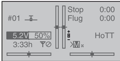
Ca. 2 Sekunden nach dem Ende der Betätigung eines der beiden Drehgeber, zeigt das Display wieder die aktuellen Trimmpositionen der vier Trimmgeber der beiden Steuerknüppel.
