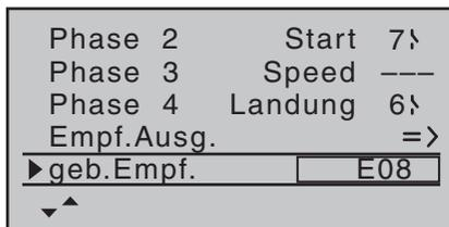
Blinkt dagegen die rote LED am Empfänger länger als ca. 10 Sekunden, ist der Binde-Vorgang fehlgeschlagen. Parallel dazu sind im Display wieder drei „---“ zu sehen. Verändern Sie ggf. die Positionen der Antennen und wiederholen Sie die gesamte Prozedur.
