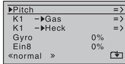
Gleich in der ersten Zeile erscheint die Funktion „Pitch“. Mit einem Antippen der zentralen **SET**-Taste der rechten Touch-Taste wechseln Sie in das entsprechende Untermenü. Hier erscheint die grafische Darstellung der Pitchkurve, die zunächst nur durch 3 Punkte definiert ist, was in den meisten Fällen auch völlig ausreichend ist.
