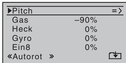
Beim Autorotationsflug wird der Hauptrotor nicht mehr durch den Motor angetrieben, sondern allein von der Eigendynamik und der Luftströmung durch die Rotorebene im Sinkflug. Da die im solcherart in Drehung gehaltenen Rotor gespeicherte Energie beim Abfangen des Hubschraubers aufgezehrt wird, ist nicht nur Erfahrung im Umgang mit Hubschraubermodellen zwingend erforderlich, sondern auch eine wohlüberlegte Einstellung der entsprechenden Funktionen.
