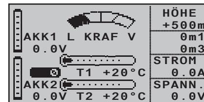
Dieses Display visualisiert die Daten eines ggf. an den Empfänger angeschlossenen General-Engine-Moduls, Best.-Nr. **33610**, oder eines General-Air-Moduls, Best.-Nr. **33611**. Näheres zu diesen Modulen finden Sie im Anhang oder im Internet unter [www.graupner.de](http://www.graupner.de) bei dem jeweiligen Produkt.
