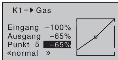
Bei *geschlossenem* Gaslimiter und ganz geöffneter Leerlauftrimmung bewegen Sie den Pitchknüppel am Minimum-Anschlag etwas hin und her. Das Gasservo darf dabei nicht mitlaufen. Damit haben Sie jetzt einen nahtlosen Übergang von der Leerlauftrimmung auf die Gaskurve. Die weiteren Einstellungen entlang der Gaskurve müssen später im Flug durchgeführt werden. Wenn Sie aus dieser Grafik heraus versuchsweise in die Autorotationsphase umschalten, erscheint anstelle der gewohnten Darstellung:
