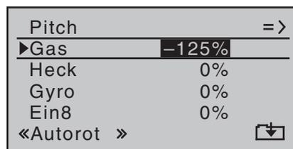
Damit ist der Motor in der Autorotationsphase (für den Notfall) sicher ausgeschaltet. Später, wenn Sie genügend Erfahrungen gesammelt haben, um den Autorotationsflug zu üben, kann hier ein stabiler Leerlauf eingegeben werden.
