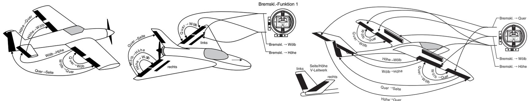
**Empfängerbelegung für Modelle mit bis zu 2 Querrudern und 2 Wölbklappen sowie Leitwerkstyp „normal“, V-Leitwerk oder mit zwei Höhenruderservos (3 + 8)**
