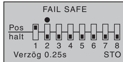
Wählen Sie anschließend mit den Pfeiltasten ◀ ▶ der linken oder rechten Touch-Taste die Option „Verzögerung“ im Display links unten an ...
