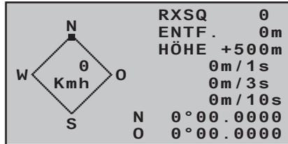
Dieses Display visualisiert die Daten eines ggf. an den Empfänger angeschlossenen GPS-Moduls mit integriertem Vario, Best.-Nr. **33600**. Näheres zu diesem Modul finden Sie im Anhang oder im Internet unter [www.graupner.de](http://www.graupner.de) bei dem jeweiligen Produkt.
