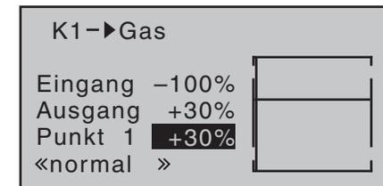
Der einzustellende Wert ist abhängig vom verwendeten Drehzahlregler wie auch von der gewünschten Soll-drehzahl und kann natürlich auch flugphasenspezifisch variiert werden.
