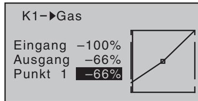
Zur *exakten* Abstimmung eines nahtlosen Überganges von der Leerlauftrimmung auf die Gaskurve ist bei geschlossenem Gaslimiter und ganz geöffneter Leerlauftrimmung der Pitchknüppel am Minimum-Anschlag etwas hin und her zu bewegen. Das Gasservo darf dabei nicht mitlaufen! Die weiteren Anpassungen der Gaskurve müssen ohnehin später im Flug durchgeführt werden.
