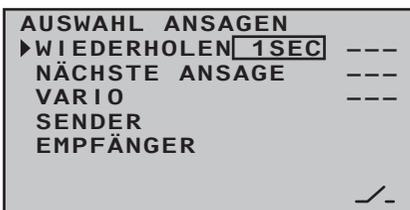
Um die Sprachausgabe über den Kopfhöreranschluss überhaupt starten zu können, ist es nötig, zumindest der Zeile „WIEDERHOLEN“ einen Schalter zuzuweisen. Dies geschieht, wie im Abschnitt „Schalter- und Geberschalterzuordnung“ auf Seite 39 beschrieben:
