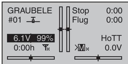
Diesen beiden Uhren kann in der rechten, am unteren Displayrand mit dem Schaltersymbol gekennzeichneten, Spalte der Zeile »Uhren« ...
