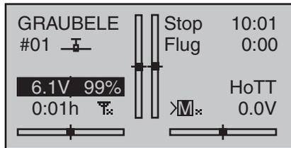
Die Stoppuhr startet nun nach Betätigung des zugeordneten Schalters bei dem eingestellten Anfangswert rückwärts („Timerfunktion“). Nach Ablauf der Zeit bleibt der Timer aber nicht stehen, sondern läuft weiter, um die nach 0:00 abgelaufene Zeit ablesen zu können. Zur eindeutigen Unterscheidung wird diese invers angezeigt.
