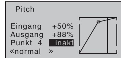
... aktiviert werden. Bewegen Sie dazu die senkrechte Linie mit dem Steuerknüppel in den entsprechenden Bereich. Sobald im inversen Wertefeld „inakt(iv)“ erscheint, kann der entsprechende Punkt durch Betätigen der Pfeiltasten der rechten Touch-Taste aktiviert und analog zu den anderen Punkten eingestellt ...
