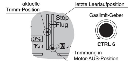
Im Gegensatz zum Flächenmodell wird diese Anzeige jedoch ausgeblendet, wenn sich der Gaslimit-Geber in der „rechten“ Hälfte seines Weges befindet:
