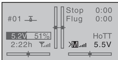
Beim Unterschreiten einer im Telemetrie-Menü Seite 126, einstellbaren Warnschwelle, standardmäßig 3,8 Volt, erfolgt eine optische und akustische Unterspannungswarnung.
