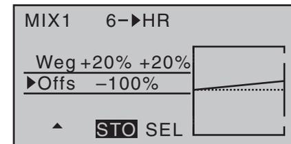
Wenn Sie jetzt den Offset von -75 % sogar auf 0 % Steuerweg zurücksetzen würden, indem Sie mit der Pfeiltaste ► der linken oder rechten Touch-Taste das **SEL**-Feld anwählen und dann gleichzeitig die beiden Pfeiltasten ▲▼ oder ◀▶ der rechten Touch-Taste
