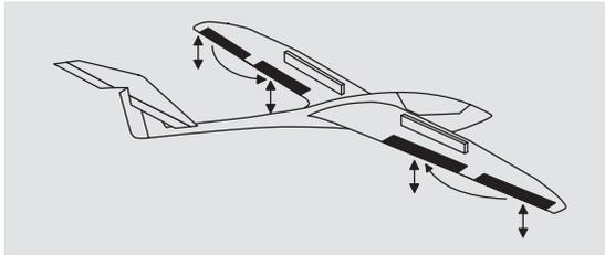
Mit diesem Mischer wird ein einstellbarer Anteil der Querrudersteuerung in die Wölbklappenkanäle eingemischt. Bei Querruderausschlag bewegen sich dann die Wölbklappen sinngemäß wie die Querruder. Normalerweise sollten die Wölbklappen den Querruderklappen aber mit einem geringeren Ausschlag folgen, d.h., der Mischanteil ist kleiner als 100 %. Der Einstellbereich von -150 % bis +150 % erlaubt, die Ausschlagrichtung je nach Drehrichtung der Wölbklappenservos sinngemäß den Querrudern anzupassen.
