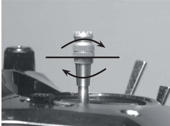
Nun durch Hoch- bzw. Herunterdrehen den Steuerknüppel verlängern oder verkürzen. Anschließend den oberen und unteren Teil des Griffstückes durch Gegenineinanderverdrehen wieder festlegen.
