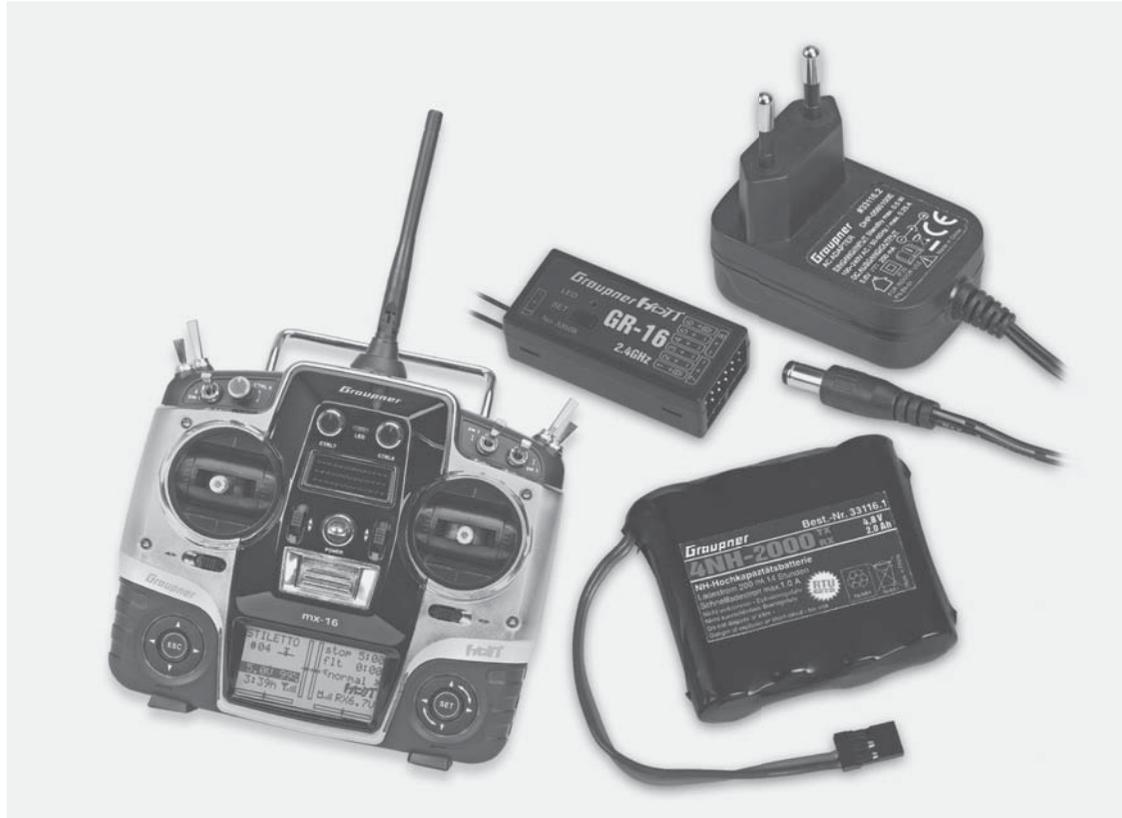
Hohe Funktionssicherheit der *Graupner* HoTT-Technologie durch bidirektionale Kommunikation zwischen Sender und Empfänger mit integrierter Telemetrie, Sprachausgabe über Kopfhörerausgang und ultraschnellen Reaktionszeiten. Programmierung durch vereinfachte Programmier-technik mit kapazitiven Berührungstasten. Kontrastreiches, 8-zeiliges blau beleuchtetes Grafik-
