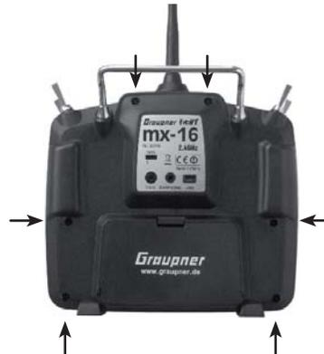
Halten Sie die beiden Gehäuseteile mit der Hand zusammen und lassen Sie diese 6 Schrauben durch Umdrehen des Senders zunächst auf eine geeignete Unterlage herausfallen. Heben Sie nun die Unterschale vorsichtig an und klappen Sie diese nach rechts auf, so, als ob Sie ein Buch öffnen würden.
