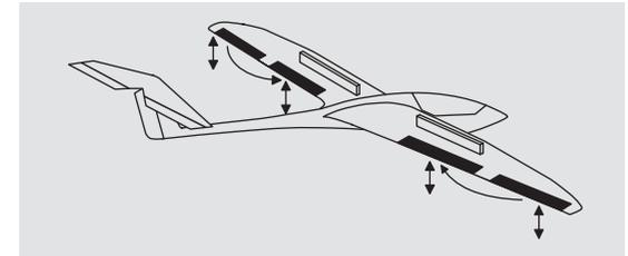
Bei Betätigung der Bremssteuerfunktion (K1-Steuerknüppel) können beide Wölbklappenservos zur Landung individuell zwischen -150 % und +150 % Mischanteil verstellt werden – üblicherweise nach unten.
