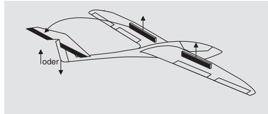
Durch das Ausfahren von Störklappen, besonders aber beim Einsatz eines Butterfly-Systems (siehe nächste Seite), kann die Fluggeschwindigkeit eines Modells ungünstig beeinflusst werden.
