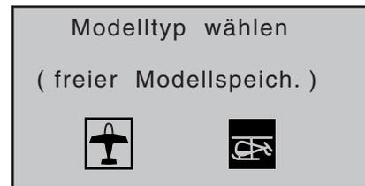
... den Modelltyp „Heli“ an. Die Anzeige wechselt unmittelbar zur Grundanzeige, wenn Sie diese Wahl mit einer Berührung der zentralen **SET**-Taste der rechten Touch-Taste bestätigen.
