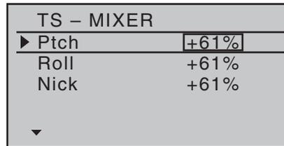
Im Menü »**Grundeinstellung**« haben Sie in der Zeile »Taumelsch.« (Taumelscheibe) festgelegt, wie viele Servos für die Pitchsteuerung in Ihrem Helikopter eingebaut sind, siehe Seite 64/65. Mit dieser Festlegung werden automatisch die Funktionen für Rollen, Nicken und Pitch entsprechend miteinander gekoppelt, sodass Sie selbst keine weiteren Mixer definieren müssen.
