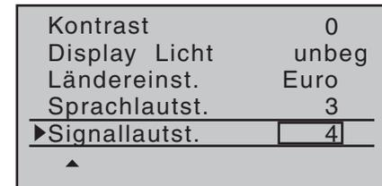
In dieser Zeile wird die Lautstärke des senderinternen Tongenerators im Bereich von „0“ bis „6“ festgelegt.
