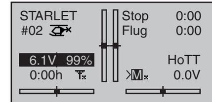
Diesen beiden Uhren kann in der rechten, am unteren Displayrand mit dem Schaltersymbol gekennzeichneten, Spalte der Zeile »Uhren« ...
