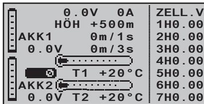
Dieses Display visualisiert die Daten eines ggf. an den Empfänger angeschlossenen Electric-Air-Moduls Best.-Nr. **33620**. Näheres zu diesem Modul finden Sie im Anhang oder im Internet unter [www.graupner.de](http://www.graupner.de) bei dem jeweiligen Produkt.
