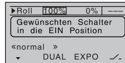
... und weisen, wie auf Seite 39 im Abschnitt „Schalter- und Geberschalterzuordnung“ beschrieben, einen Schalter zu. Der zugewiesene Schalter erscheint in der Displayanzeige zusammen mit einem Schaltersymbol, das die jeweilige Schaltrichtung des Schalters anzeigt.
