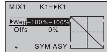
Anschließend wechseln Sie in die Zeile „Offs“. Parallel dazu werden die Felder **SYM** und **ASY** durch **STO** und **SET** ersetzt. Schieben Sie nun den K1-Knüppel bei inversem **STO**-Feld bis zum Anschlag in die von Ihnen gewählte Motor-„AUS“-Position und berühren dann die zentrale **SET**-Taste der rechten Touch-Taste. Der Wert rechts neben „Offs“ wechselt daraufhin von 0 % zu ca. +100 % und die grafische Darstellung der Mischerkennlinie rechts daneben ändert sich ebenfalls entsprechend:
