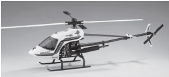
Als Programmierbeispiel dient der rechtsdrehende Hubschrauber STARLET 50 von *Graupner*, mit 3 um jeweils 120° versetzte Anlenkpunkte vom Taumelscheibentyp „3Sv(2 Roll)“, Einsteigerabstimmung ohne erhöhte Gaskurve; ohne Heading-Lock-Gyrosystem wie auch ohne senderseitige Gyrobeinflussung des „Normal-
