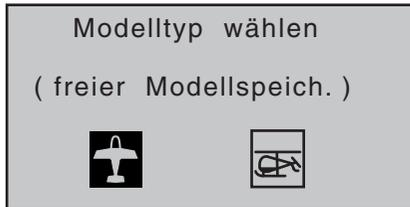
Da wir uns in diesem Abschnitt mit einem Flächenmodell beschäftigen wollen, wird das Symbol für ein Flächenflugzeug mit einem Antippen der zentralen **SET**-Taste der rechten Touch-Taste bestätigt. Das Display wechselt wieder zur Grundanzeige.
