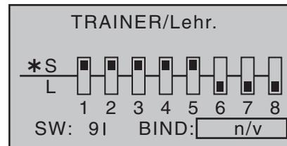
... und lösen Sie erst beim Schüler-Sender mit einem Antippen der zentralen **SET**-Taste der rechten Touch-Taste den „BINDEN“-Prozess aus ...
