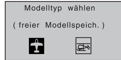
Wählen Sie mit den Tasten ◀ oder ▶ der linken oder rechten Touch-Taste den grundsätzlichen Modelltyp an und berühren Sie die zentrale **SET**-Taste der rechten Touch-Taste. Damit wird der ausgewählte Modellspeicher mit dem ausgewählten Modelltyp initialisiert und das Display wechselt wieder zur Grundanzeige. Der Speicherplatz ist entsprechend vorbelegt.
