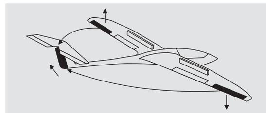
Das Seitenruder wird in einstellbarem Maße bei Querrudersteuerung mitgenommen, wodurch insbesondere in Verbindung mit der Querruderdifferenzierung das negative Wendemoment unterdrückt werden kann, was ein „sauberes“ Kurvenfliegen erleichtert. Das Seitenruder bleibt natürlich weiterhin getrennt steuerbar.
