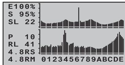
*Obere Reihe: Empfangsleistung in dBm der Kanäle 1 ... 75 des 2,4 GHz-Bandes.*
