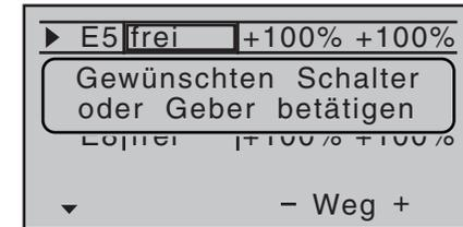
Betätigen Sie nun den gewünschten Geber (CTRL 6 bis 10) oder den ausgewählten Schalter (SW 1 bis 3, 8 oder 9), wobei zu beachten ist, dass die Proportional-Drehgeber erst nach einigen „Rasten“ erkannt werden, also etwas länger betätigt werden müssen. Wenn der Stellweg nicht mehr ausreicht, betätigen Sie den Geber gegebenenfalls in Gegenrichtung.
