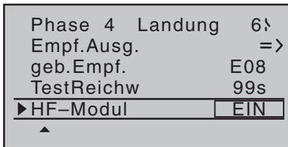
Nun können Sie mit den rechten Pfeiltasten zwischen **OFF** und **ON** auswählen. Mit einer erneuten Berührung der zentralen **SET**-Taste der rechten Touch-Taste schließen Sie die Eingabe ab.
