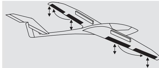
Um eine gleichmäßigere Auftriebsverteilung über die gesamte Spannweite zu erzielen, wird mit diesem Mischer ein einstellbarer Anteil der Wölbklappensteuerung in die Querruderkanäle 2 und 5 übertragen. Dadurch bewegen sich die Querruder bei Wölbklappenausschlag sinngemäß wie die Wölbklappen, normalerweise aber mit geringerem Ausschlag.
