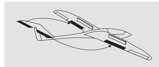
Zur Unterstützung des Höhenruders bei engem Wenden und beim Kunstflug kann die Wölbklappenfunktion über diesen Mischer durch die Höhenrudersteuerung mitgenommen werden. Die Mischrichtung ist so zu wählen, dass bei gezogenem Höhenruder die Klappen nach unten und umgekehrt bei gedrücktem Höhenruder (Tiefenruder) nach oben – also gegenläufig – ausschlagen. Gleichzeitiges Antippen der Tasten ▲ ▼ oder ◀ ▶ der rechten Touch-Taste (**CLEAR**) setzt einen geänderten Wert wieder auf 0 % zurück.
