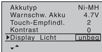
In dieser Zeile wird festgelegt, wie lange die Hintergrundbeleuchtung des Displays nach dem Einschalten
