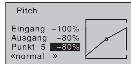
Wenn Sie nun in die Autorotationsphase schalten – links unten im Display wird der Flugphasenname «Autorot» eingeblendet – erscheint die „alte“ Pitchkurve wieder. Stellen Sie nun die gleichen Werte wie in der Normalphase ein. Lediglich bei Punkt 5 – bei Pitch-Maximum – kann der Pitchwinkel um etwa 2 ° vergrößert werden. Damit hat man später (!) beim Autorotieren etwas mehr Einstellwinkel zum Abfangen des Modells.
