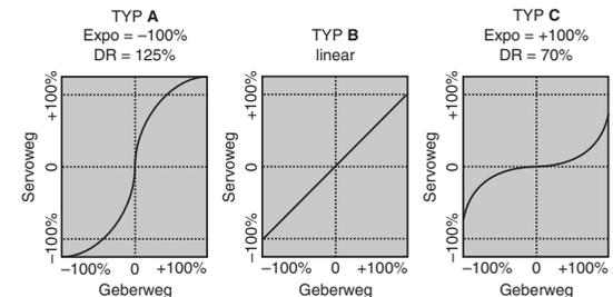
In der Regel wird eine nichtlineare Steuerfunktion ggf. verwendet für Querruder (Kanal 2), Höhenruder (Kanal 3) und Seitenruder (Kanal 4). Diese Vorgaben entsprechen auch der Werkseinstellung. **ABER ACHTUNG:** Diese Zuordnung trifft nur dann zu, wenn Sie sender-
