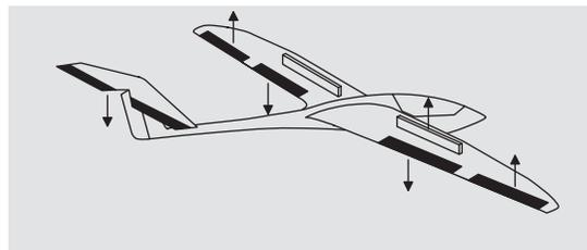
Dieses Zusammenspiel der Wölbklappen und Querruder sowie des Höhenruders dient zur Gleitwinkelsteuerung beim Landeanflug. (Die Butterfly-Klappenstellung wird vor allem in Zweckmodellen häufig anstelle von Brems- bzw. Störklappen verwendet.)
