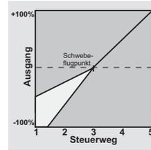
Wenn Sie dieses Flugbild erreicht haben, stellen Sie den Wert für „Gas min“ – den Wert von Punkt 1 auf der Grafikseite von „K1 → Gas“ – so ein, dass die Drehzahl weder zu- noch abnimmt. Die Abstimmung von Gas und Pitch ist damit abgeschlossen.
