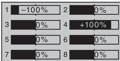
Die aktuelle Stellung eines jeden Servos wird unter Berücksichtigung der Geber- und Servoeinstellungen, der Dual-Rate-/Expo-Funktionen, des Zusammenwirkens aller aktiven Mischer usw. in einem Balkendiagramm exakt zwischen -150 % und +150 % des normalen Weges angezeigt. 0 % entspricht genau der Servomittelstellung. So können Sie schnell Ihre Einstellungen überprüfen,
