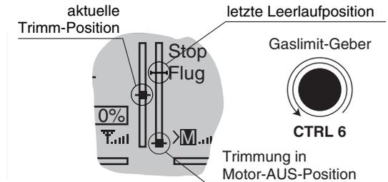
Aus diesem Grund wird die K1-Trimmanzeige auch vollständig ausgeblendet, solange sich der Gaslimit-Drehgeber rechts der Mittenposition befindet:
