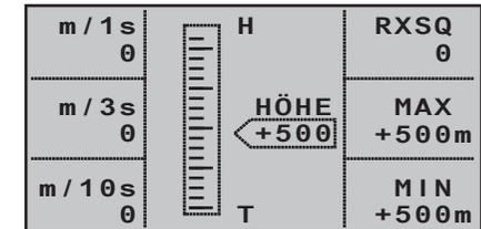
Dieses Display visualisiert die Daten eines ggf. an den Empfänger angeschlossenen Vario-Moduls Best.-Nr. **33601**. Näheres zu diesem Modul finden Sie im Anhang oder im Internet unter [www.graupner.de](http://www.graupner.de) bei dem jeweiligen Produkt.
