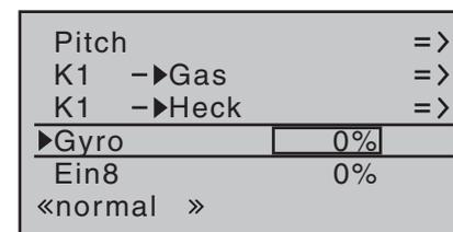
Basierend auf diesen flugphasenspezifisch festgelegten (Offset-) Einstellungen kann die Gyrowirkung mit einem in der Zeile „Gyr“ im Menü »**Gebereinstellung**« (Seite 78) zugewiesenen Geber, z. B. CTRL 8, zusätzlich stufenlos variiert werden:
