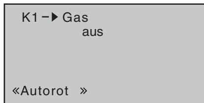
Das bedeutet, dass das Gasservo auf einen Festwert geschaltet ist, der wie folgt eingestellt werden kann: Gehen Sie mit **ESC** zurück zur Menüliste. Solange Sie sich noch in der Autorotationsphase befinden, werden neue Untermenüs aufgelistet.
