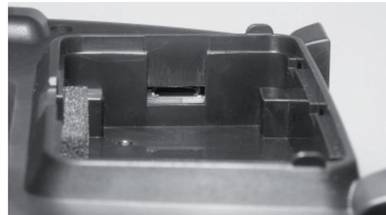
Es können alle handelsüblichen micro-SD-Speicherkarten mit bis zu 2 GB und micro-SDHC-Karten mit bis zu 32 GB Speicherplatz verwendet werden. Herstellerseitig empfohlen wird jedoch die Verwendung von Speicherkarten mit nur bis zu 4 GB, da dies im Normalfall völlig ausreicht.
